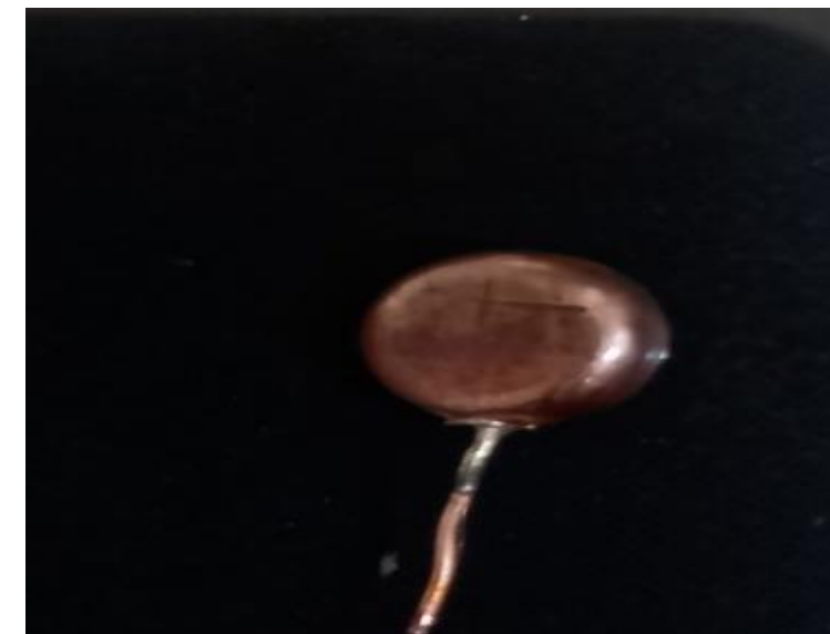
تصویر کاتد ساخته شده چشمه یونی سیکلوترون کلاسیک
