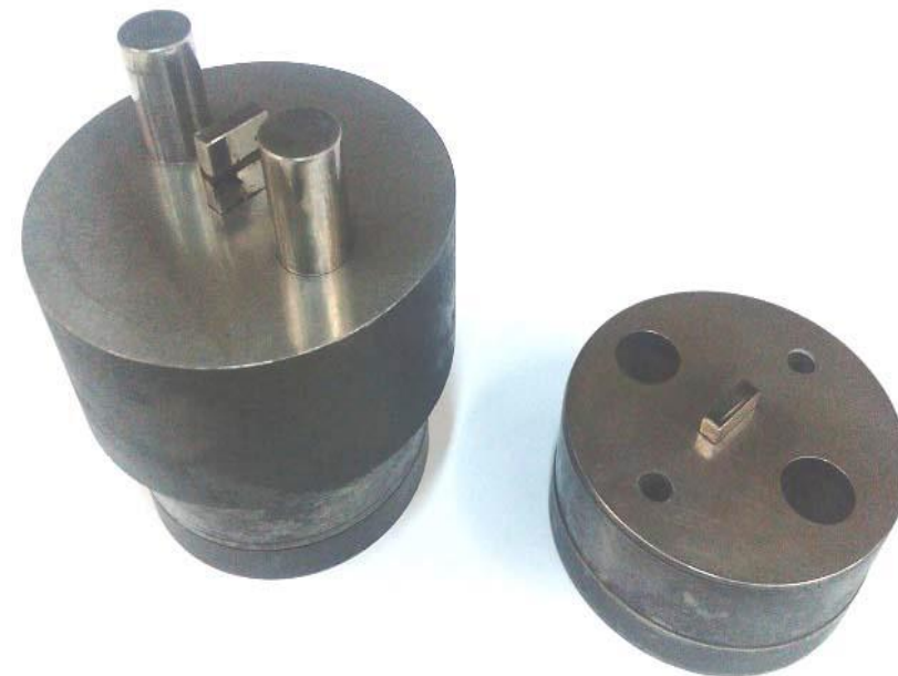
شکل قالب پرس مستطیلی برای نمونه های پودری
